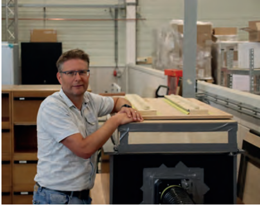
Peter Kuindersma bij een zelfgemaakte experimentele opstelling om de luchtdichtheid van hsb-elementen te testen.
