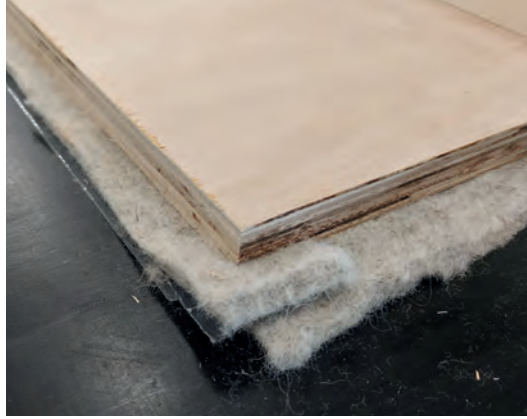
Een proefstuk waarin luchtdichting met schapenwol werd onderzocht.
