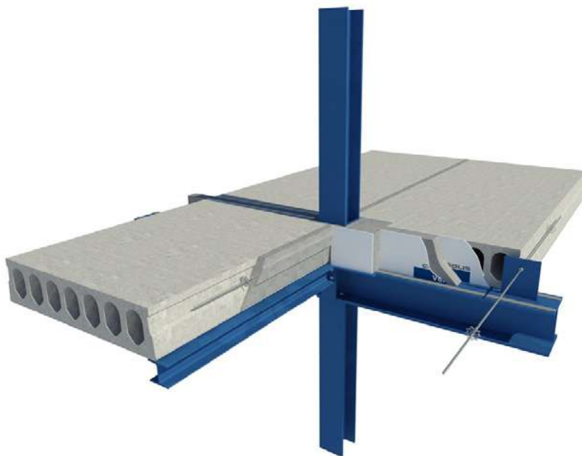
Figuur 17 — Betonnen kanaalplaatvloer (2)
