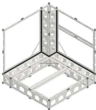
Figuur 1: Draagstructuur met manifold, samengestelde hoofdliggers, kolom met ombouw, gridcel vloer, enkelvoudig frame gevel en herbruikbare EPDM afdichtingsprofielen voor luchtdichte afwerking
