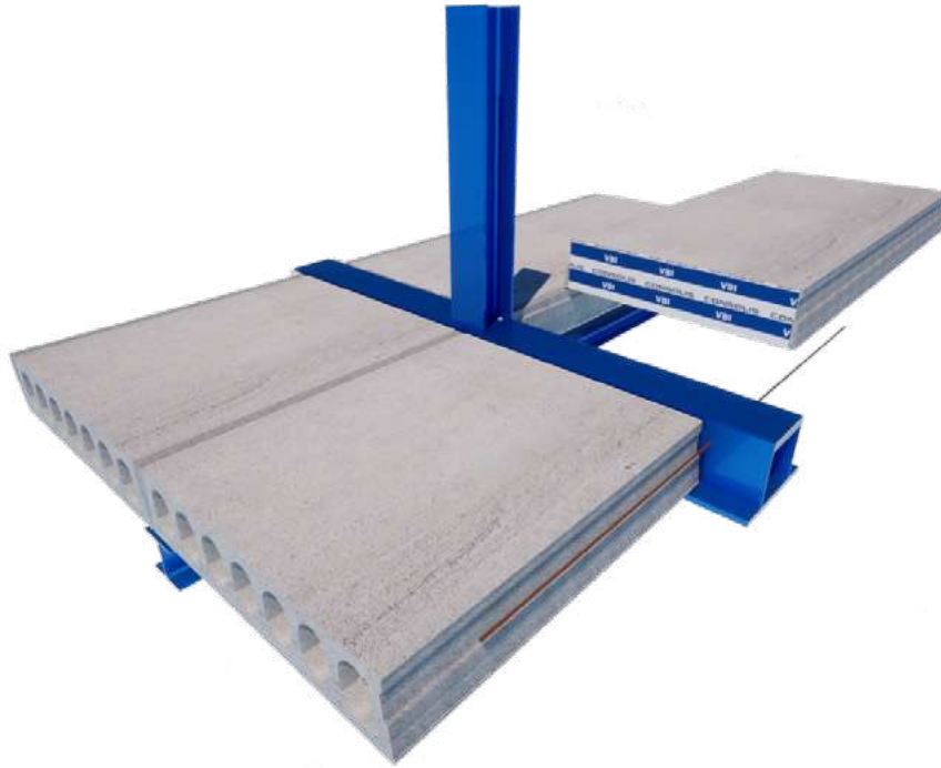
Figuur 16 — Betonnen kanaalplaatvloer (1)
