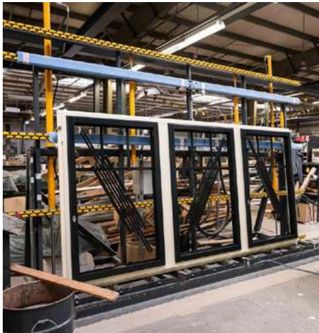
Figuur 1: Productie kozijnen (inclusief stelkozijn)
