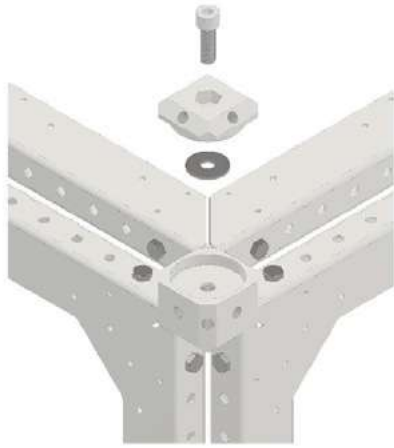
Figuur 5: Hoek vloergrid verbonden aan basisknoop met de mogelijkheid om een opzetstuk te plaatsen voor de koppeling van een systeemwand, orthogonaal of desgewenst schuingeplaatst
