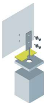
3: Koppeling van de module aan de fundering
