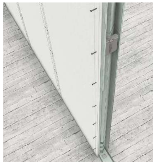
Figuur 7: Bevestiging panelen met schroeven
